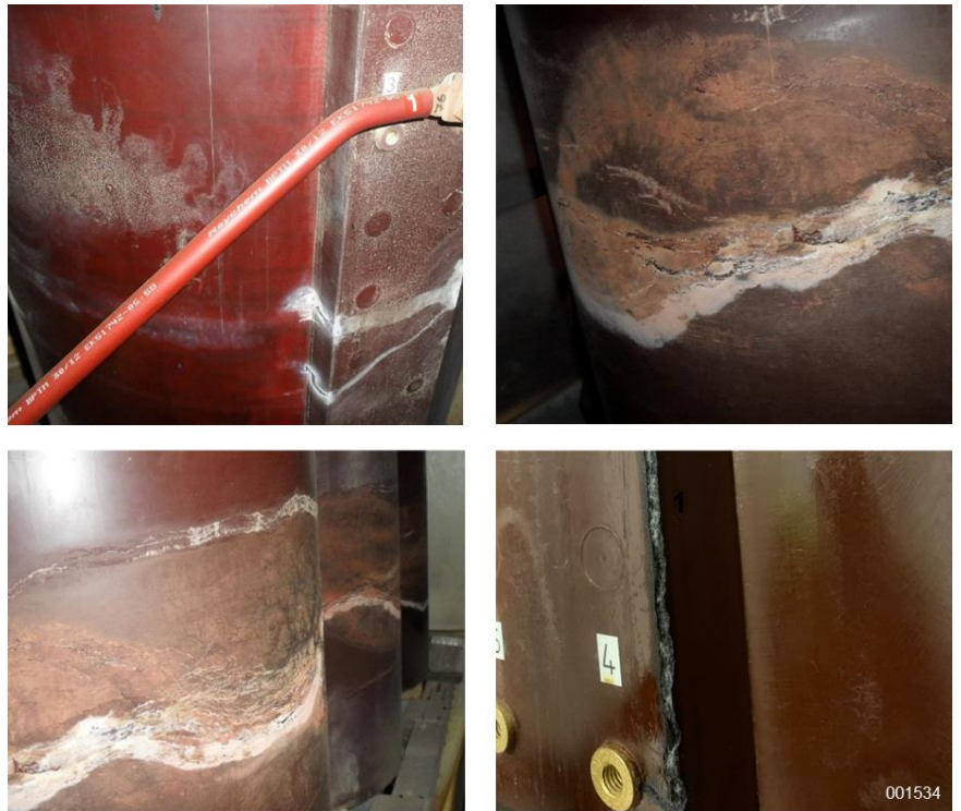
Εικ. 24: Ίχνη ερπυσμού και ίχνη μερικής εκφόρτισης
