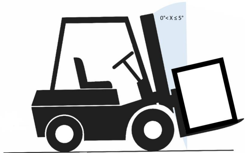
Εικ. 9: Γωνία κλίσης για τη μεταφορά με περονοφόρο ανυψωτικό όχημα
